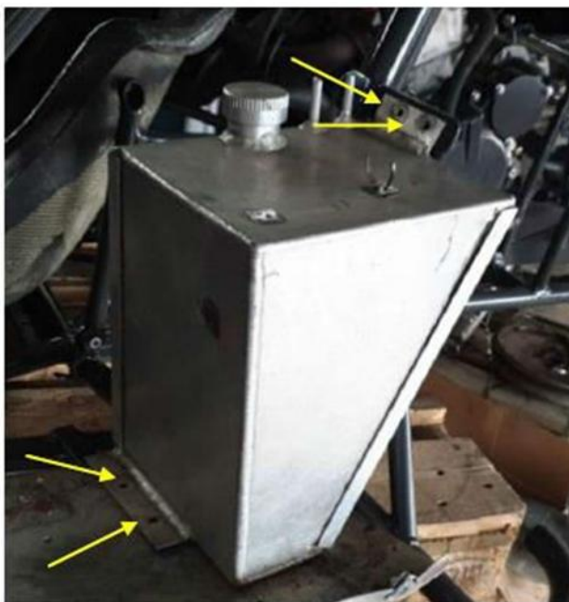
Bild 2 Befestigungen des Tanks:
